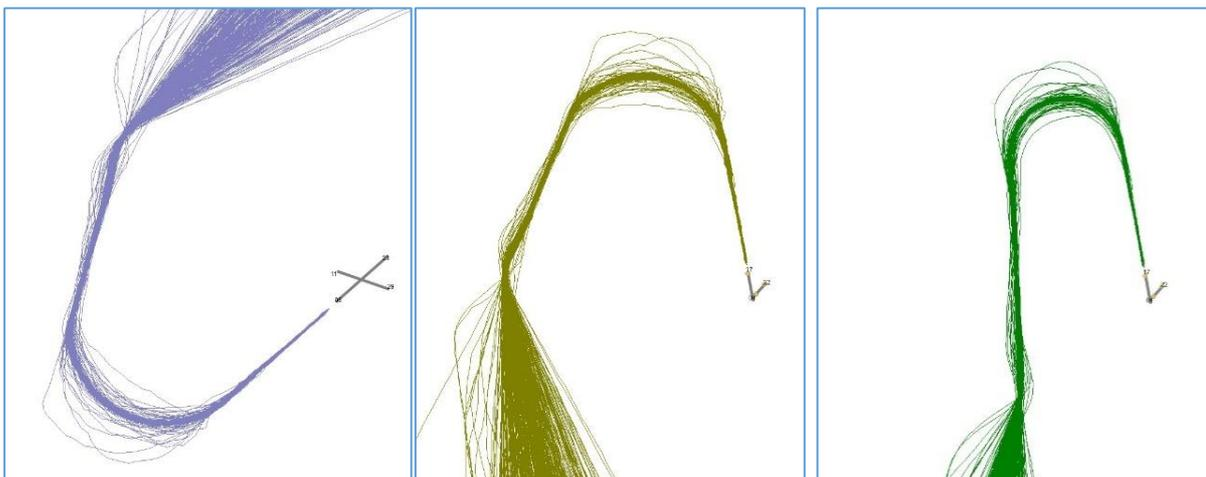
**Figure 24 : Obtention du flux RNP-AR - 1) Utilisation du flux RNP Visual de Bordeaux (à gauche) & 2) Transposition à Cannes (au centre) & 3) Déformation (à droite)**
